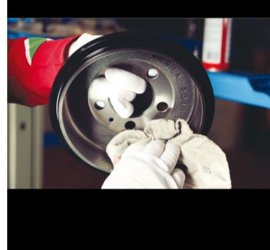
Von der Bremsschelle der neuen Trommel mit einem Lappen den schützenden Ölfilm und alle Fettspuren gründlich entfernen.
