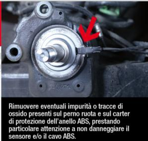
Rimuovere eventuali impurità o tracce di ossido presenti sul perno ruota e sul carter di protezione dell'anello ABS, prestando particolare attenzione a non danneggiare il sensore e/o il cavo ABS.
