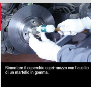
Rimontare il coperchio copri-mozzo con l'ausilio di un martello in gomma.
