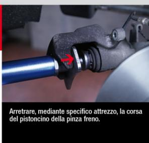
Arretrare, mediante specifico attrezzo, la corsa del pistoncino della pinza freno.
