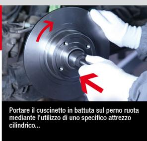
Portare il cuscinetto in battuta sul perno ruota mediante l'utilizzo di uno specifico attrezzo cilindrico...
