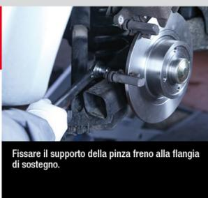
Fissare il supporto della pinza freno alla flangia di sostegno.
