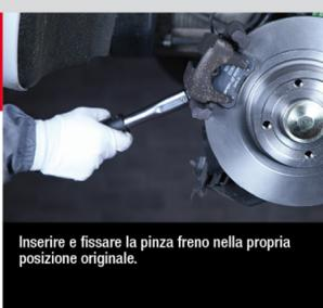
Inserire e fissare la pinza freno nella propria posizione originale.
