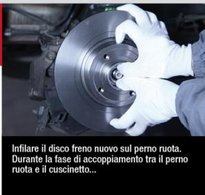
Infilare il disco freno nuovo sul perno ruota. Durante la fase di accoppiamento tra il perno ruota e il cuscinetto...
