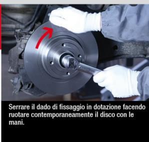
Serrare il dado di fissaggio in dotazione facendo ruotare contemporaneamente il disco con le mani.
